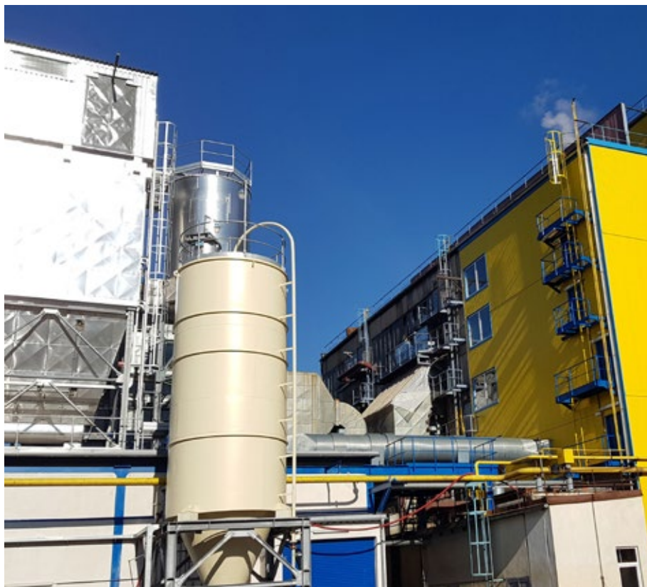
Obr. 13 – Odsíření a odprášení kotle K7.
